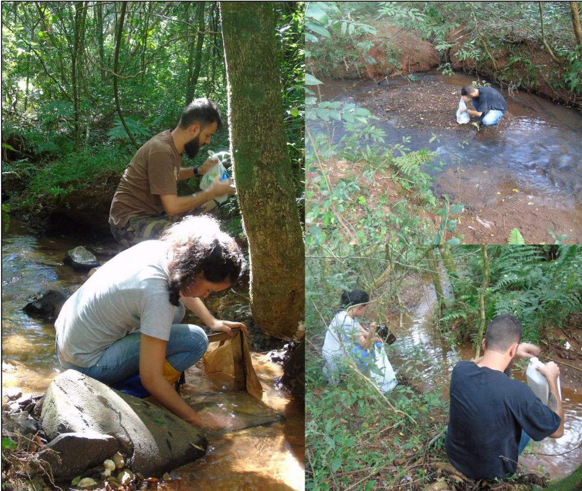
**Figura 49.** Coletas de água realizadas no Parque Urbano Municipal Arlindo Hass, bem como, avaliação de macroinvertebrados bentônicos com coletor Surber (à esquerda).
